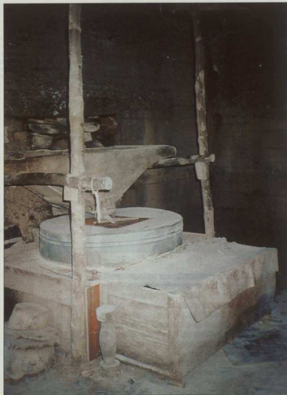
3. Αρκαδία, Κάτω Γιανναίοι. Αλεσιτικός μηχανισμός νερόμυλου. Διακρίνονται η κοφινίδα για το άλεσμα, η πανοριά περιστρεφόμενη μολόπετρα και η αλευροκασέλα.
