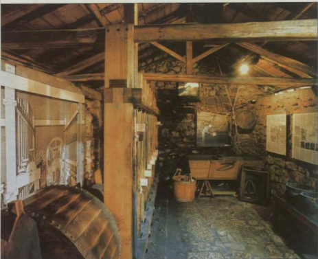
4. Υπαίθριο Μουσείο Υδροκίνησης στη Δημητσάνα. Λειτουργούσα ανακατασκευή μηχανισμού μπαρουτμούλου με κοπάνια (φωτ. Αρχείο Π.Ι.Ο.Π.).
