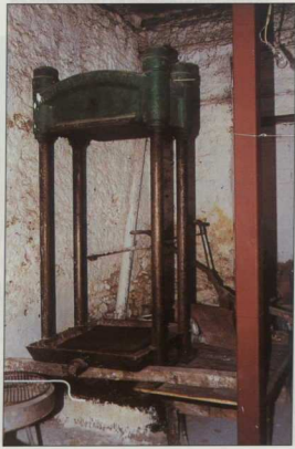
4. Θουρία. Ελαιοτριβείο Αποστολάκη. Το υδρολικό πιεστήριο του οικου Victor Coq.
