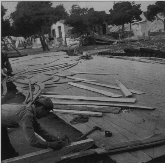
5. Σάλα (δάπεδο ναυπηγική οχεδίασμού) σε ναυπηγείο του Περάματος (φωτ. Βούλα Παπαϊωάννου), Μουσείο Μπενάκη.
