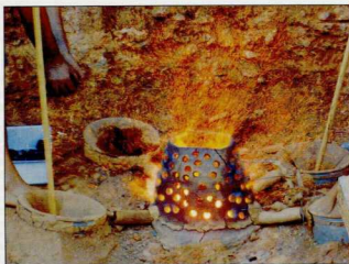
1. Η «φρασιώδης» μεταλλουργική κλίμακα σε πλήρη λειτουργία κατά τη διάρκεια υπαίθριων πειραματικών προσομοίωσης της παραγωγής πρώιμου χαλκού, με βάση τα ανασκαφικά ευρήματα της ΠΙΜ-II θέσης Χρυσοκάμινο της Άνωτ. Κρήτης. Δεξιά διακρίνονται τα χειροκίνητα φούρα και τα θερμοζεύγη για τη μελέτη της εσωτερικής θερμοκρασίας.
