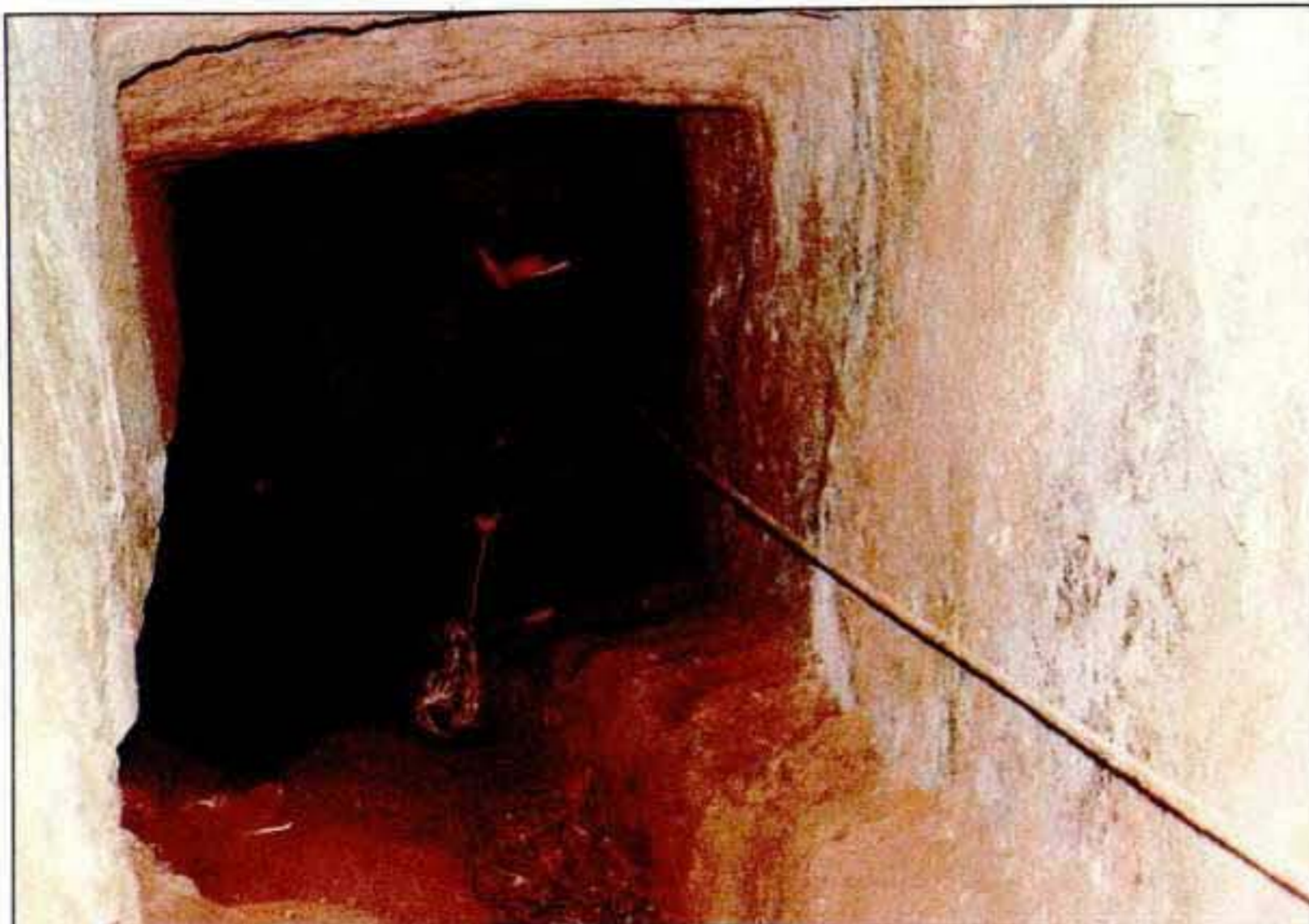
6. Κάθετη λαξευτή στοά 2x2x15 μ. εξαερισμού ορυχείου. Λεπτομέρεια.
