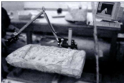
3. Παράδειγμα σάρωσης αρχαιολογικού αντικείμενου από τρισδιάστατο σαρωτή λέιζερ στα Προπύλαια.
