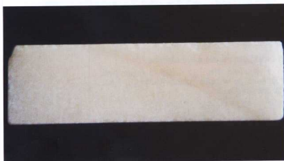
8. Το δοκίμιο της Πάρου πριν από τον καθαρισμό με πάστα \text{NH}_4\text{HCO}_3 .
