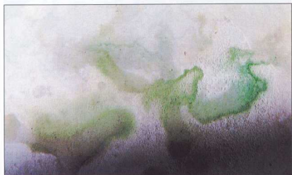
3. Λεπτομέρεια από το δοκίμιο του Διονυσίου. 4. Στο στερεοκόπιο Λεπτομέρεια των επικαθίσεων αλάτων χαλκού στο δοκίμιο του Διονυσίου.
