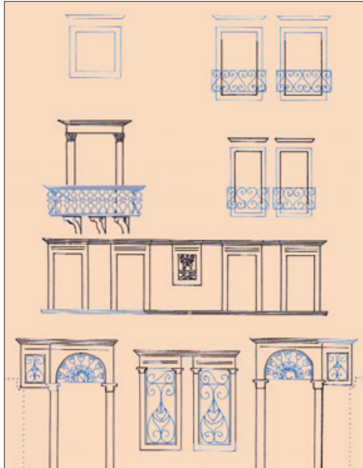
7. Προτεινόμενο σχέδιο αναστήλωσης της πρόσοψης του αρχοντικού. Με μαύρο τα υφιστάμενα στοιχεία, με γαλάζιο τα προς συμπλήρωση και αποκατάσταση.
