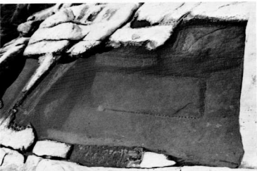
πέτρας. Μέ φάλκα (αύλακι) ελευθερώνει και τις υπόλοιπες τρεις πλευρές και με σφήνες (ή με λαστούς) αποκολλά την πέτρα από την κάτω πλευρά. Άλλη περίπτωση είναι, αν η ποιότητα της πέτρας τού επιτρέπει, δύο πλευρές να ελευθερωθούν συγχρόνως με τη χρήση σφήνων (για την τεχνική της πέτρας βλ. Όρλανδος Β).
