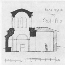
21. Τομὴ τοῦ ναοῦ τοῦ Σωτήρος ἢ τῆς Θεοτόκου, ὅπως ἀποδείχθηκε ἀπὸ τῆς τελευταίας ἐρευνες γιὰ τὴν ἀποκατάσταση τοῦ μνημείου μετὰ τὸ σεισμό τοῦ 1978.
