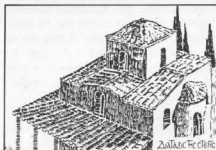
5. Οἶκος Δαυίδ. Ἡ κάτοψη τοῦ ναοῦ ἦταν ἀρχικὰ τετραγώνη με ἠμικυκλικὴ κόγχη στὸ ἀνατολικά. Στὶς 4 γωνίες τοῦ τετραπλευροῦ ὑπῆρχαν τετραγώνια διαμερισμάτα καὶ ὁ ὑπόλοιπος χώρος διαμορφωνόταν, στὴν κάτοψη, σέ σχῆμα ἐγγεγραμμένου σταυροῦ, ποὺ οἱ κεραίες του στεγαζόνταν με ἠμικυλινδρικές καμάρες, ἐνῶ τὸ σημεῖο συνάντησης τῶν καμαρῶν στεγαζόταν με τρούλλο (α,β). Σήμερα ἔχει ἀλλάξει ἡ μορφή τῆς στέγασης κι ἕνα μέρος τοῦ ναοῦ, στὸ δυτικά, ἔχει καταστραφεί καὶ ἡ εἰσοδος εἶναι στὴ νότια πλευρὰ (γ,δ). Στὸ τεταρτοσφαίριο τῆς κόγχης ὑπάρχει τὸ ψηφιδωτὸ τοῦ Χριστοῦ, ὁ ὅποιος εἰκονίζεται σύμφωνα με τὸ ὄραμα τοῦ Ἱεζεκιήλ καὶ εἶναι στὸ κέντρο τῆς παράστασης, καθισμένος σέ τόξο μέσα σέ «δόξα». Ἡ «δόξα» περιβάλλεται ἀπὸ τὰ σύμβολα τῶν 4 ἀγγελλιστῶν, ἀγγελό, ἀετὸ, λιοντάρι καὶ μοσχάρι. Κάτω ἄριστερα παριστάνεται ὁ προφήτης Ἱεζεκιήλ καὶ δεξιά ὁ προφήτης Ἀββακούμ (ε). α. Κάτοψη καὶ τομὴ κατὰ μήκος τῆς ἀρχικῆς φάσης τοῦ ναοῦ. β. Ἀναπαράσταση τῆς ἀρχικῆς στέγασης τοῦ ναοῦ. γ. Κάτοψη τοῦ ναοῦ στὴ σημερινή μορφή του κατὰσση. δ. Ἡ σημερινὴ στέγαση τοῦ ναοῦ. ε. Τὸ ψηφιδωτὸ τῆς κόγχης τοῦ Ἱερου.
