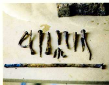
6. Ὄξειδωμένα μεταλλικὰ καρφιά πού συγκρατοῦσαν τὰ πρόσθετα τμήματα τοῦ ἀκρόρπρωρου.
