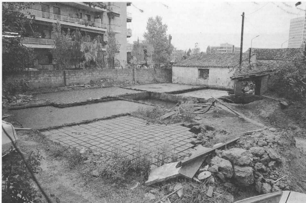
7. Οι «απλωστρες, αθαβείς δεξαμενές όπου στραγγίζει ο υδαρής πηλός και κόβεται σε κύβους.
