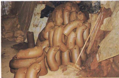
9. «Μπλαστρούρια», δηλαδή κυλινδρικά κομμάτια έτοιμου πηλού, διαστάσεων 0,35 x 0,15, που θγαίνουν από το μηχανικό ζυμωτήριο. Από αυτά θα πάρει ο αγγειοπλάστης για να πλάσει τα αγγεία.
